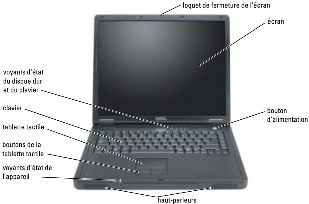
**LOQUET DE FERMETURE DE L'ÉCRAN** — Appuyez sur ce bouton pour dégager le loquet de fermeture de l'écran et ouvrir ce dernier.
